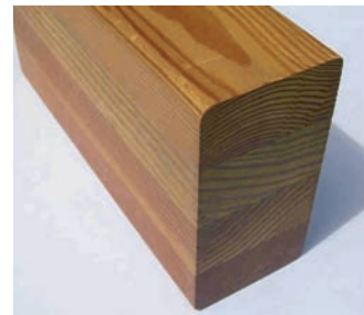
Ejemplo de madera laminada encolada./ An example of glued laminated wood.
